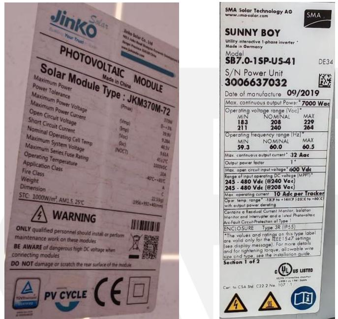
Ficha técnica del módulo fotovoltaico e inversor respectivamente.
