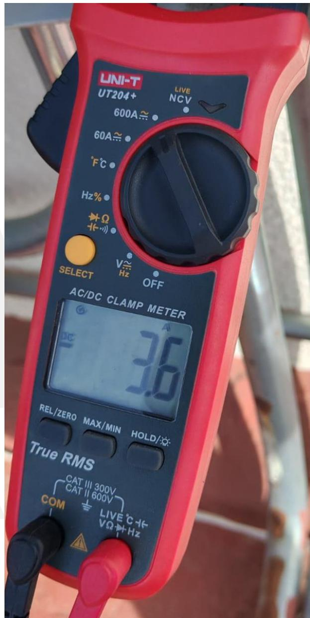
También se realizaron mediciones eléctricas de corriente alterna, este circuito es el de salida del inversor.
