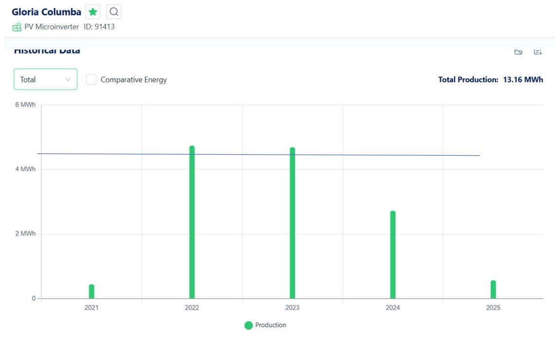
Se observa que el sistema en los años 2022 y 2024 alcanzo a generar el estimado calculado **4.5 Mwh**.
